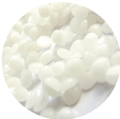
Продукт представляет собой мягкий и липкий твердый материал от светло-желтого до белого цвета. Микрокристаллический воск имеет ряд преимуществ: липкость, адгезионная способность к инертным материалам, низкая температура плавления и вязкость
